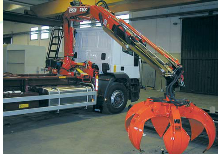
Veicolo Iveco 2 assi allestito con attrezzatura scarrabile ribaltabile posteriore da 20 Tonn. e gru con polipo
