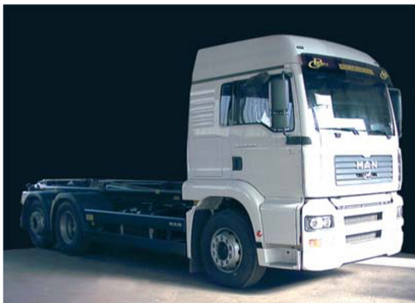
Veicolo Man 3 assi allestito con attrezzatura scarrabile ribaltabile posteriore da 26 Ton.
