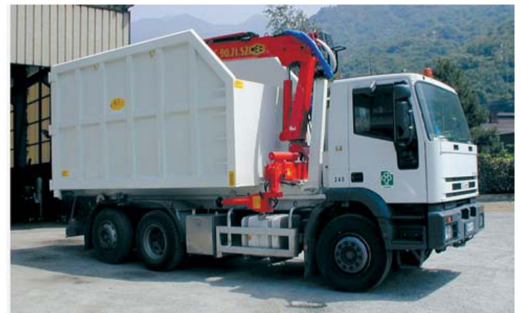
Veicolo Iveco 3 assi allestito con attrezzatura scarrabile ribaltabile posteriore e cassone scarrabile da 30 mc in materiale antiusura con caricatore e polipo
